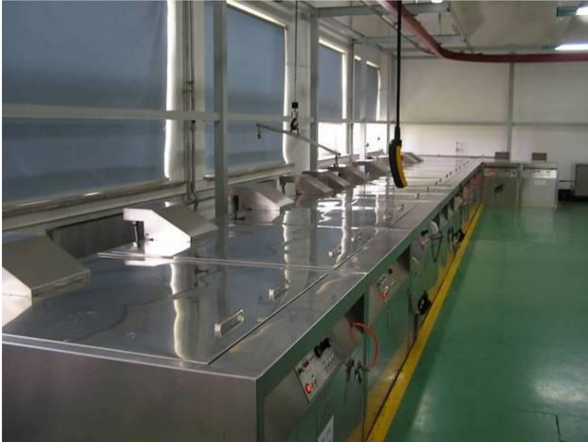
• 荧光渗透检测线
